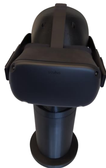
Abbildung 04: 3D-Kopfmodell mit HMD angebracht an der Halterung
