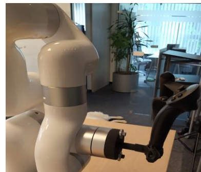
Abbildung 03: Motion Controller mit Adapter am Roboterarm angebracht
